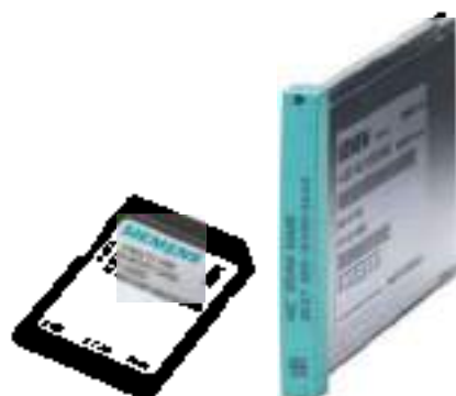
Figura 2.17. Diferentes tipos de tarjetas de memoria para autómatas programables (Fuente Siemens AG).
