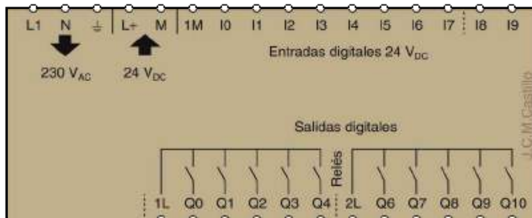
Figura 2.50. PLC con entradas DL y salidas a relé.
