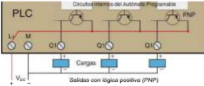
Figura 2.30. Salidas DC con lógica positiva.
