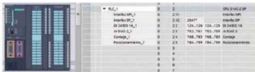
Figura 9.17. Entradas y salidas analógicas en un S7-300.
