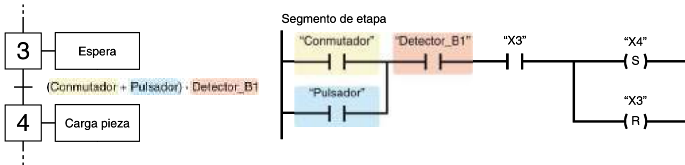
Figura 8.16. Segmento con el modo de funcionamiento manual/automático.
