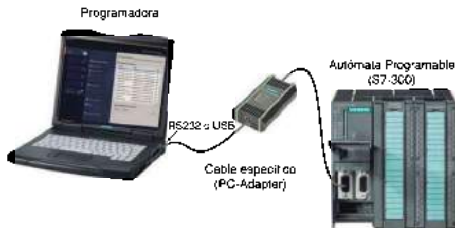
Figura 4.57. Conexión de un S7-300 a la programadora
