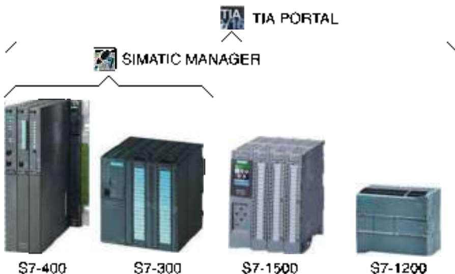
Figura 4.2. Automatizadores programables SIEMENS programables en STEP 7
