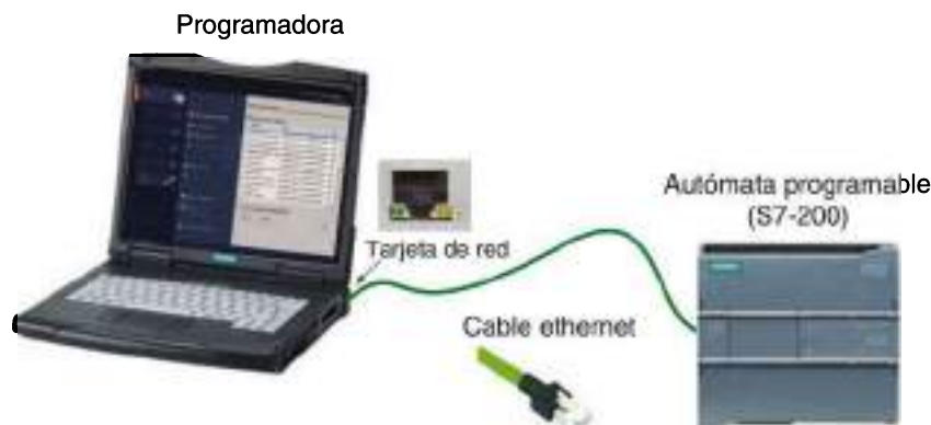
Figura 4.51. Conexión Ethernet entre la programadora y el PLC.
