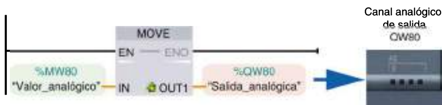
Figura 9.21. Transferencia a una salida analógica desde una variable.
