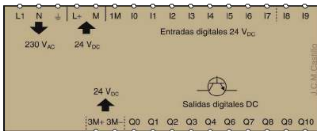
Figura 2.51. PLC con entradas y salidas DL.
