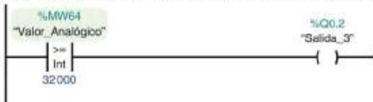
Figura 9.20. Ejemplo de uso de una señal analógica de entrada.
