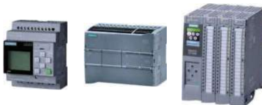
Figura 2.2. Diferentes modelos de autómatas programables (Fuente Siemens AG).
