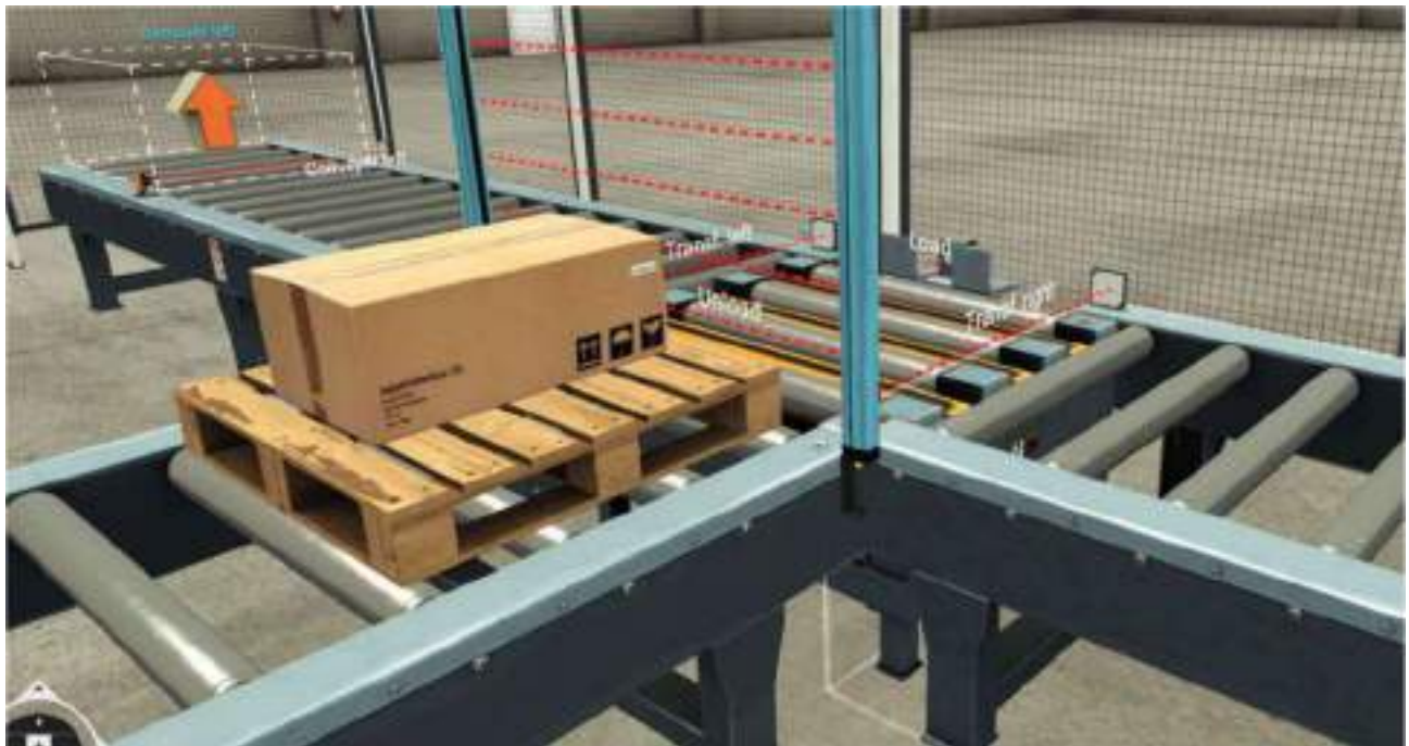
Figura 10.7. Detalle de la detección de la altura de las cajas con la barrera fotoeléctrica en la entrada de los rodillos centrales. (Fuente: Real Games).
