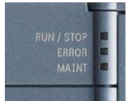
Figura 2.14. Led indicadores del modo de funcionamiento de la CPU.
