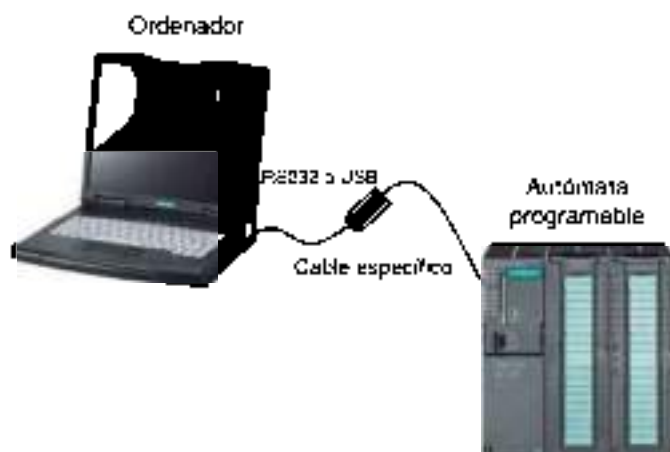
Figura 2.40. Cable de programación específico
